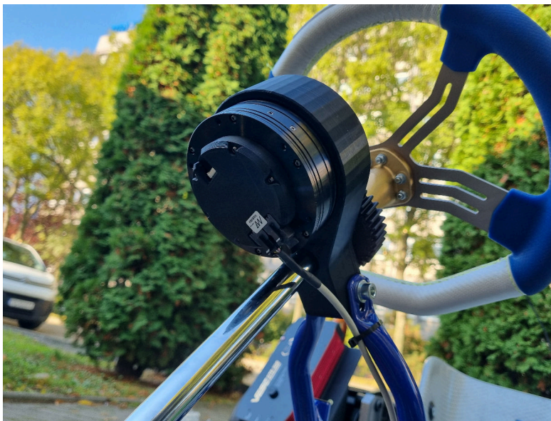
Rysunek 11: Zastosowany silnik to AK80-8 CubeMars T-Motor z sterownikiem firmy MAB robotics.
