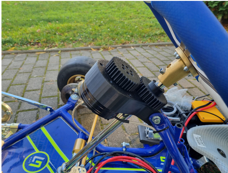
Rysunek 10: Mocowanie silnika kolumny kierowniczej zamocowane na gokarcie.
