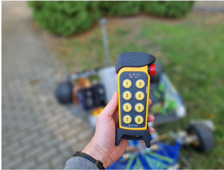
Rysunek 14: E-Stop pozwalający na bezpieczne zatrzymanie pojazdu
